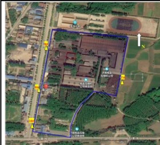
7-1 无组织废气检测点位示意图
